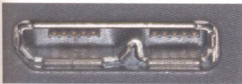
rys. 60.17. Interfejs USB 3.0 micro-B: a) w urządzeniu, b) wtyk
