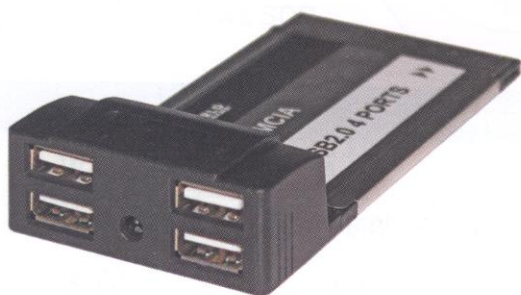
Rys. 60.21. Wewnętrzne kontrolery USB: a) kontroler PCMCIA do laptopa, b) kontroler PCI do komputera PC
