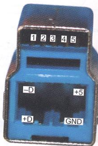
Rys. 60.16. Budowa wtyku USB 3.0 typu B 1, 2, 4, 5 – pary sygnałowe SDP, 3 – GND
