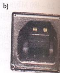
Rys. 60.13. Gniazda USB: a) w komputerze, b) w urządzeniu
