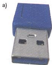
Rys. 60.15. Wtyk USB 3.0 Super Speed: a) typu A, b) typu B-D12345GND+D+5
