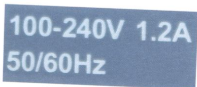
Rys. 11.3. Przykład oznaczenia urządzenia zasilanego prądem przemiennym
