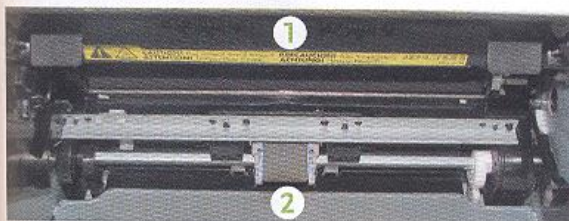
Rys. 61.8. Układ utrwalania papieru (1) i układ podający (2)
