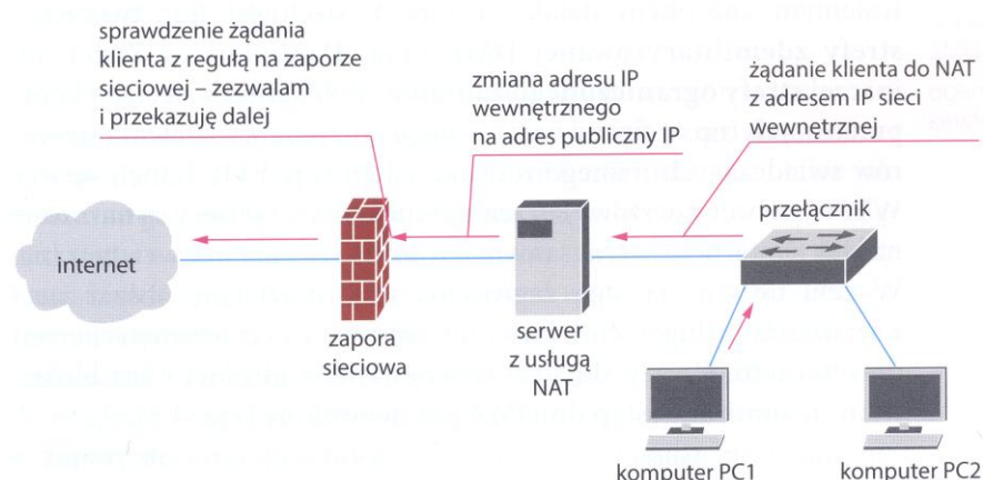
Rys. 4.3. Usługa NAT na zaporze sieciowej
